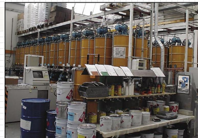
Bombas de válvula de bola de 1" instaladas en una operación de mezcla y entintado de pinturas.
