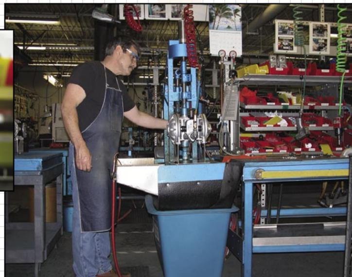
Un armador experimentado de Warren Rupp monitorea el desempeño de la bomba con medidores de presión y vacío.
