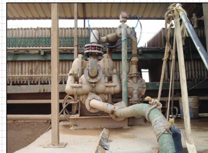
Bomba de uso rudo hecha sobre pedido para aguas residuales, sistema de bombeo de presión de filtro.
