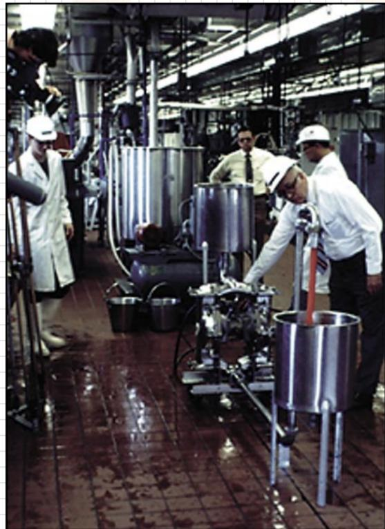
**Bomba de válvula de cierre de bola certificada por la USDA en una instalación de limpieza de tubería sanitaria.**
