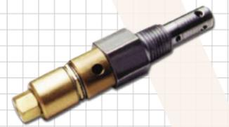
**DETECTOR DE FUGAS MECÁNICO:** Cuando una fuga ataca químicamente una arandela interior de este detector, activa un émbolo. Este abre una válvula de aire que, a su vez, activa un solenoide proporcionado por el cliente (o un dispositivo similar) para activar una señal.
