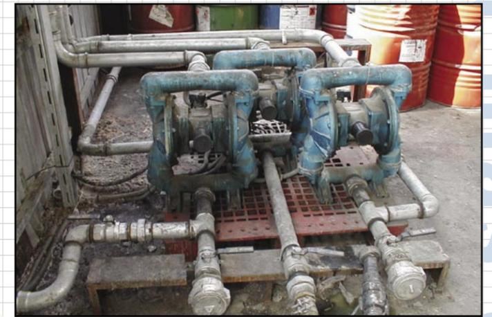
Las bombas metálicas de tarea estándar portátiles son ideales para actividad intermitente/por demanda, para fluidos moderadamente abrasivos y sólidos suspendidos. Las bombas metálicas de tarea estándar se construyen en aluminio, hierro fundido, acero inoxidable y Aleación C con elastómero TPE (elastómeros de plástico térmico) y opciones PTFE en diafragmas y válvulas de cierre.
